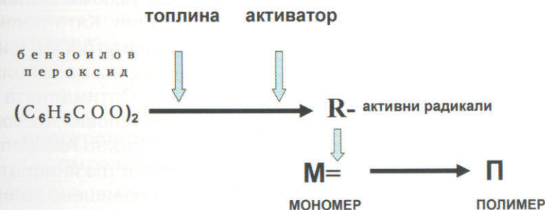
Фиг. 135. Фактори, разпадащи бензоиловия пероксид на активни радикали, които разкъсват реактивоспособните функционални групи на мономерите
