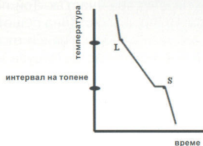
Фиг. 106. Време-температурна крива на сплав тип механична смеси
