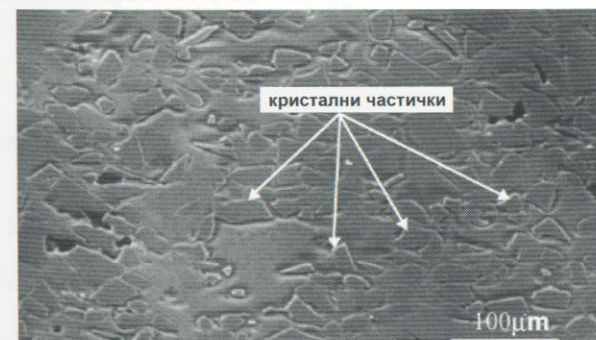
Фиг. 174. Микроскопска снимка на разпръснати кристали от алуминиев оксид в аморфна фелдшпатова стъкловидна структура (по А. Neral)
