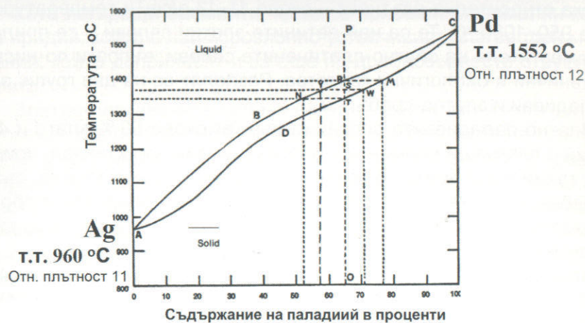
Fig. 117. Диаграма за състоянието на бяла благородна сплав. (по R. Craig и J. Powers)
