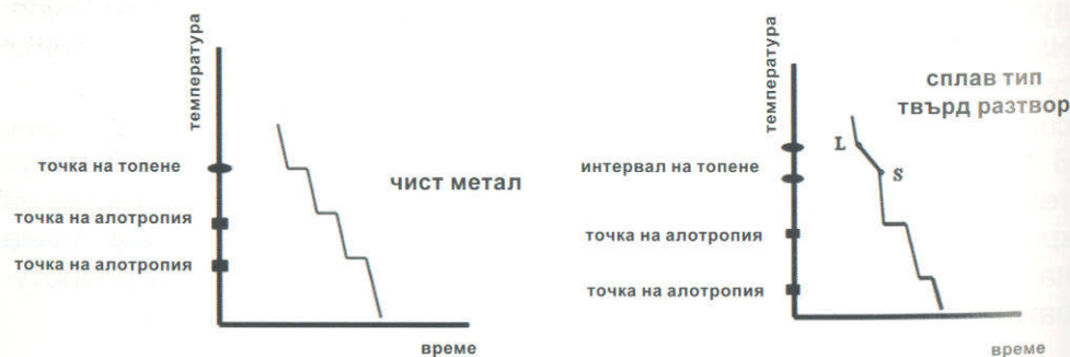
Фиг. 107. Алотропни превръщания на чист метал и на сплав тип твърд разтвор
