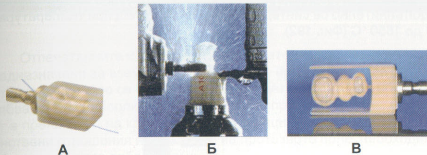
Фиг. 190. CAD/CAM – техника: А – избор на керамично блокче според големината на конструкцията; Б – оформяне на керамичното блокче в изпиляващата машина; В – изпилена протезна конструкция
