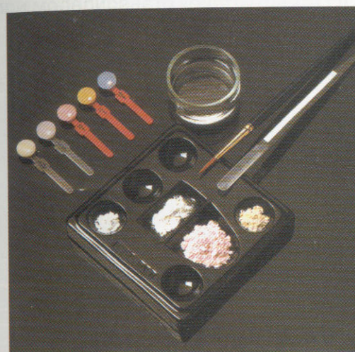
Фиг. 164. Смесване на порцеланови прахове с вода: А – зъботехническа палитра; Б – тиксотропната порцеланова каша от емайлови и дентинови маси не тече благодарение на пластификаторите
