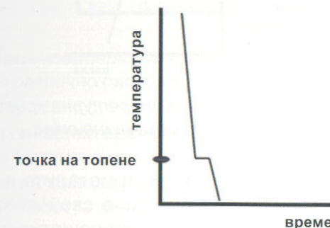
Фиг. 104. Време-температурна крива на чист метал
