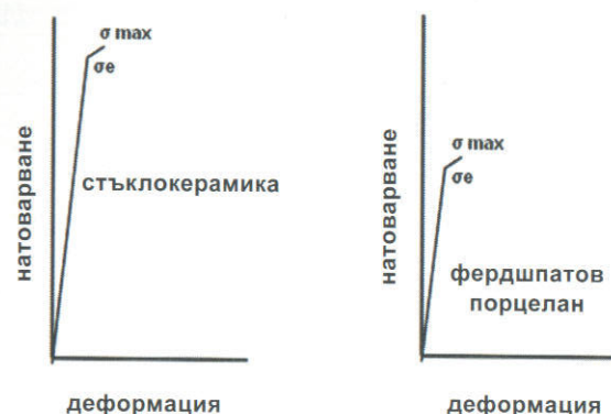
Фиг. 32. Диаграми натоварване-деформация на крежки материали
