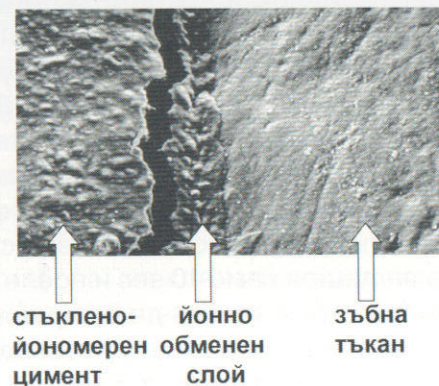
Фиг. 279. Кохезивна фрактура на стъкло-йономерен цимент (по Н. Ngo и кол.)
