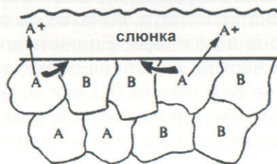
Фиг. 125. Корозия при хетерогенна структура. Кристалните зърна А са по-електроотрицателни спрямо кристалните зърна В. Стрелките показват преноса на йони (по J. McCabe и A. Walls)
