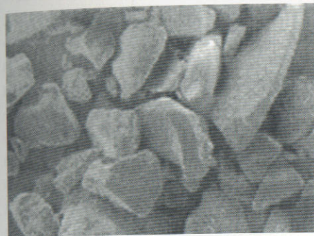
Фиг. 145. Полимер, получен след блокова полимеризация (по A. Parrish)
