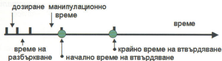
Фиг. 63. Схема на втвърдяването на гипса във времето
