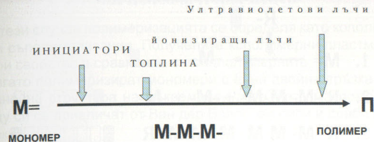
Фиг. 134. Фактори, които разкъсват реактивоспособните функционални групи на мономера и превръщането му в полимер
